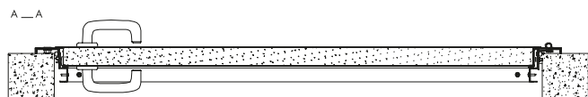
Rys. 68. Przekrój poziomy drzwi stalowych płaszczonek zewnętrznych ECO BASIC UNI z ościeżnicą narożną.
